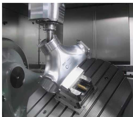
Sprawdzanie kolizji z uwzględnieniem wszystkich kinematyk obrabiarki.
