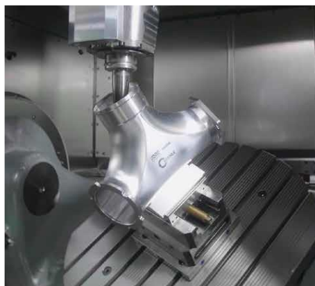
Sprawdzanie kolizji z uwzględnieniem wszystkich kinematyk obrabiarki.
